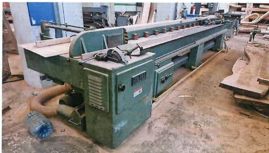
Sharre skajuese me bango 5.5 metra per çarjen e trungjeve te medhenj, procesi zgjajt 1 sharrim per min
