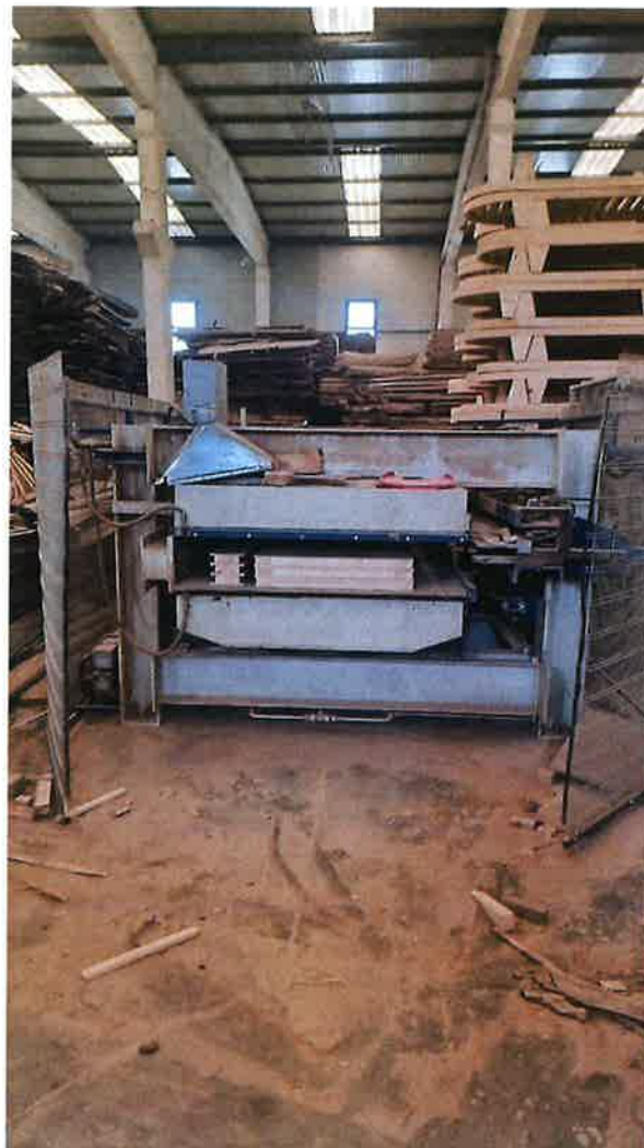
Prese automatike me bord 4 faqe per prodhim dyersh dhe tavolinash, procesi zgjat rreth 7 min
