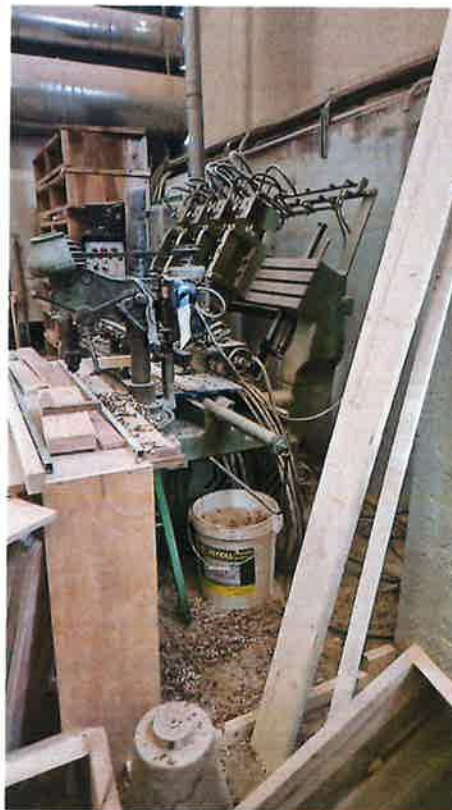
Torno kopjuese megaton per prodhim elemente ne seri me bord te automatizuar
