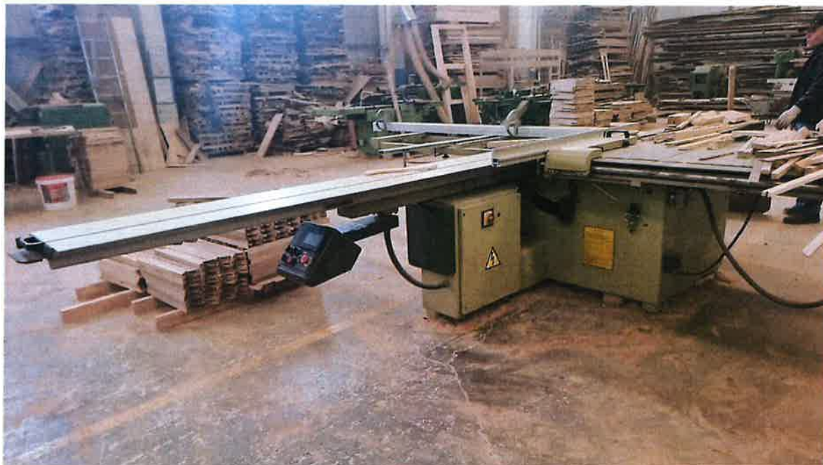
Karrel skajues per prodhim kapak guzhine dhe elemente te tjere te drurit
