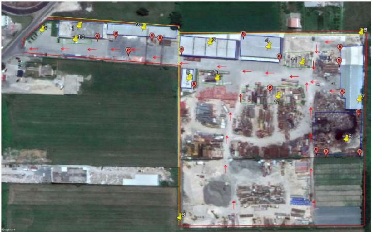
Figura 9. Plani i evakuimit dhe skica e përgjithshme e mjeteve dhe pajisjeve kundër zjarrit
