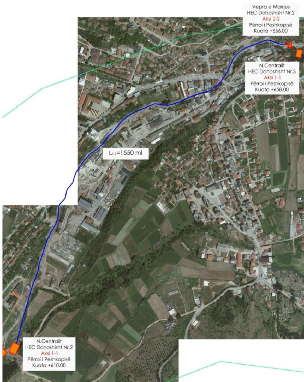
Figura Nr.7 – Planimetria e Tubacionit te Turbinave (Aksi 1-2) HEC-i Dohoshisht 2 – Rrethi Diber
