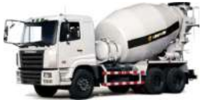
Mjet transportues i betonit.
