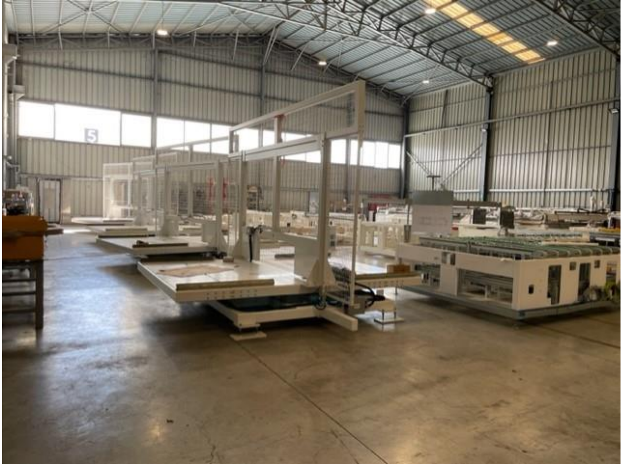
Pjese te asambuara te bazes se makinerive qe do te krijohen ( furra per stampimin e xhamave )
