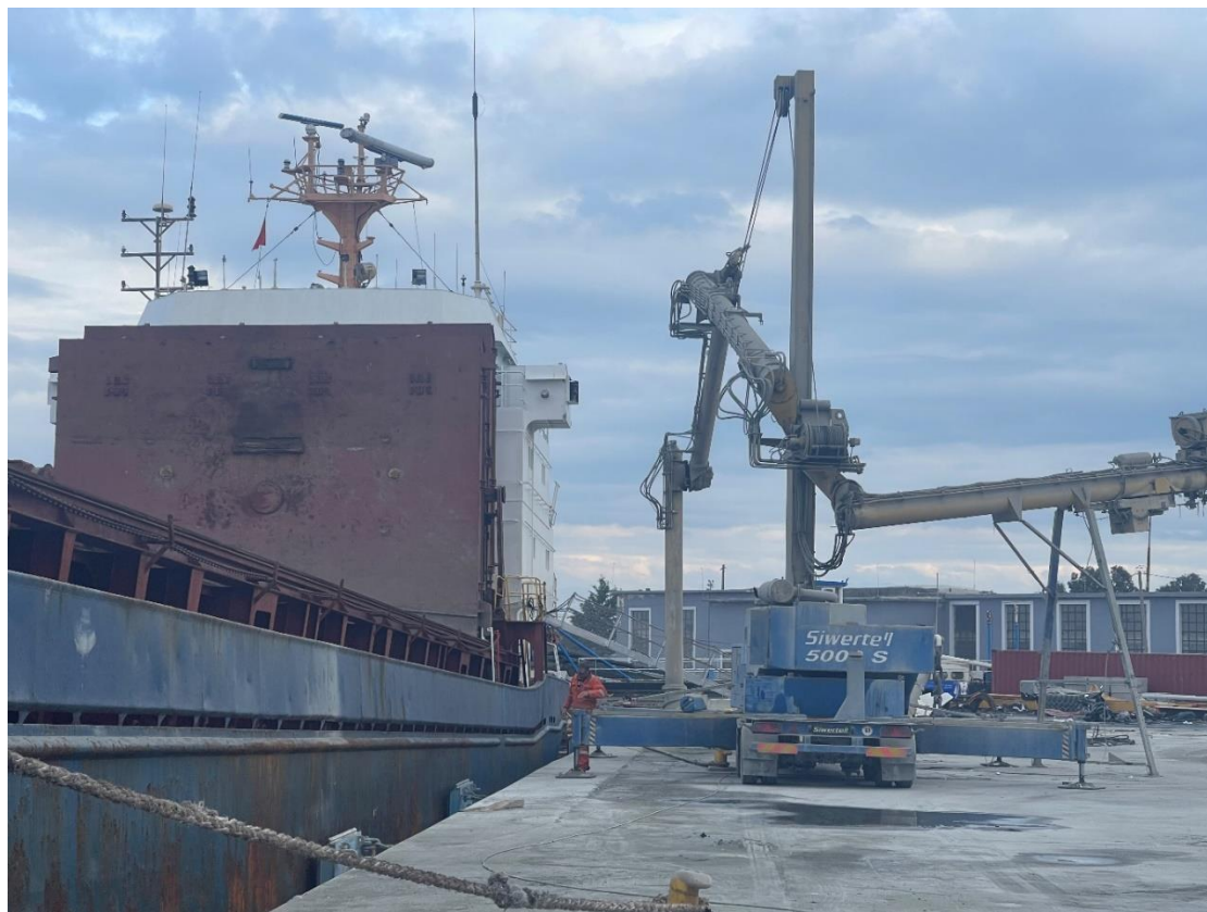
Kompresori pneumatik me atë të të cilit k ryhet ngarkim/shkarkimi i çimentos nga kamioni në anije
