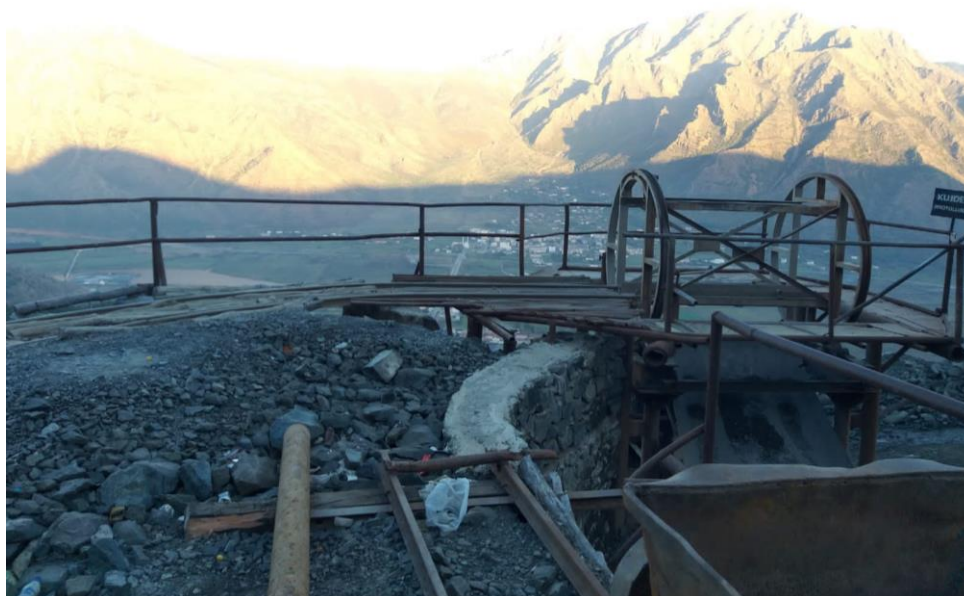
Sheshi para hyrjes se galerise, rrotulluesi i vagonave me mineral
