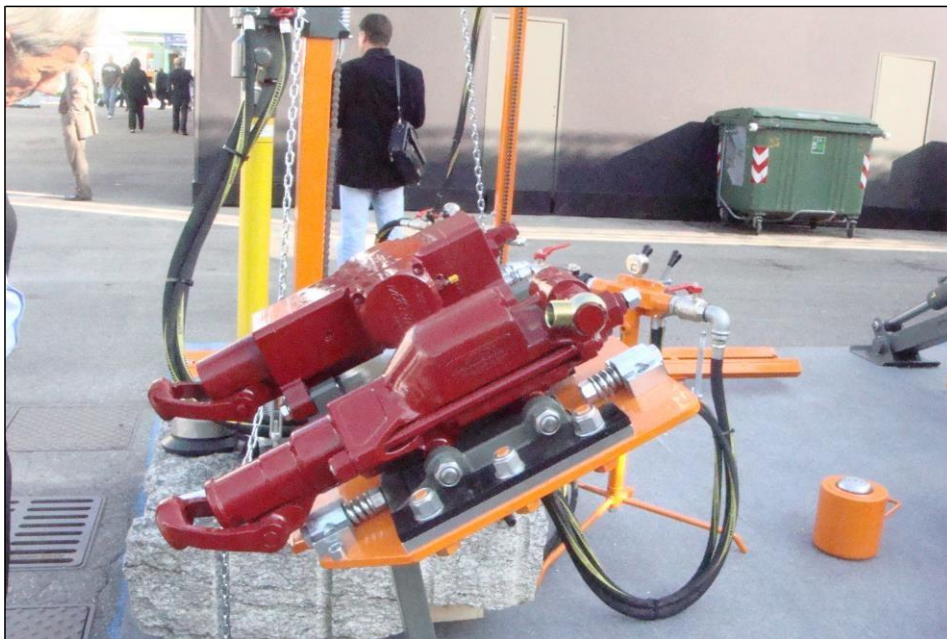
Çekiç shpimi me per sonden shpuese Tip « MARINI »
