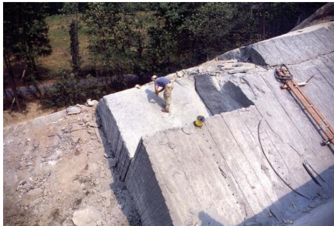
Futja e fitilit detonant ne birat e nje prerje paresore
