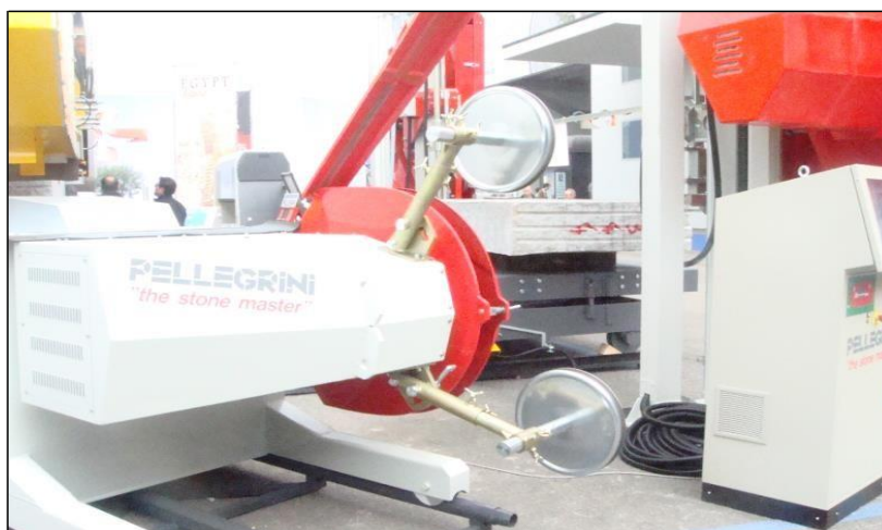
Impiant peres me tel te diamantuar i tipit PELLEGRINI
