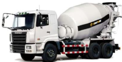
Mjet transportues i betonit.
