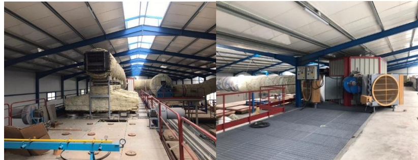
Figura 24. Pamja e sistemit te kapjes se nxehtesis dhe tharjes se tullave
