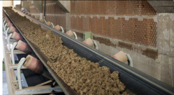
Figura 21. Transportjeri per dergimin e argjiles tek thermuesi
