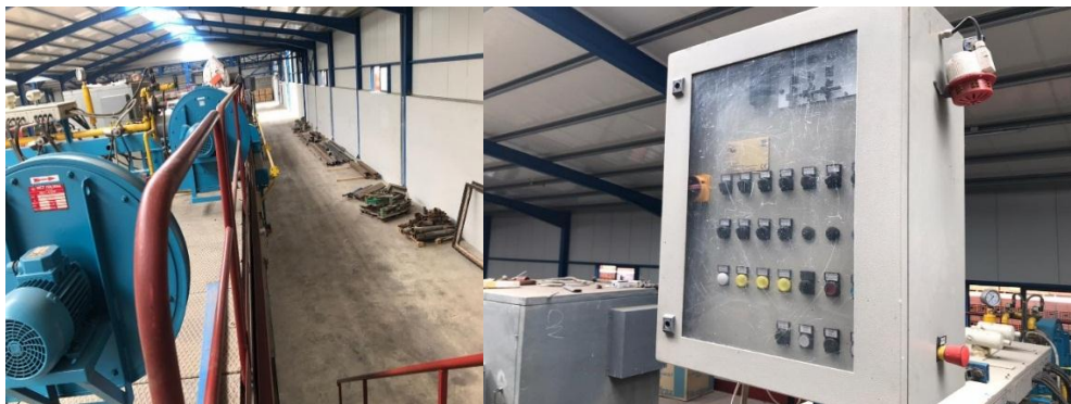
Figura 27. Pamje e brucatoreve mbi furre dhe e panelit te komandimit te gazit
