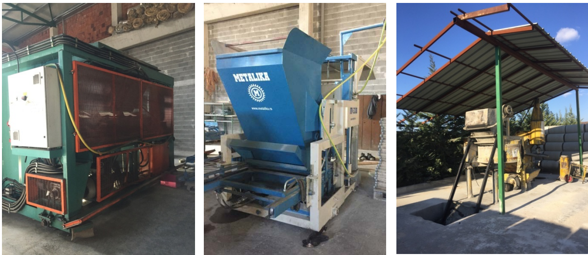
Fig. 2. Makinaria e prodhimit te pusetave e bordurave, makinaria e prodhimit te blloqeve, makinaria e prodhimit te tubave (nga e majta ne te djathte).
