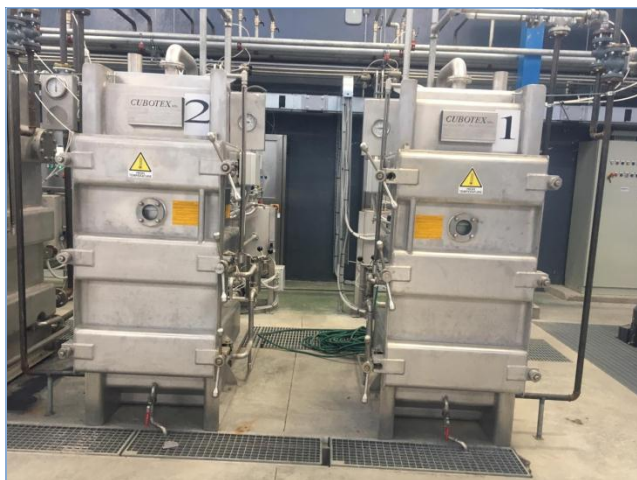
Linja Teknologjike e ngjyrosjes se Tekstileve – Makine Ngjyrosese
