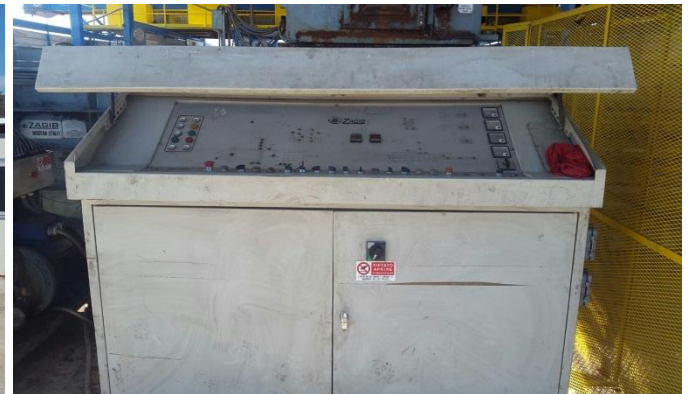
Paketa me ane te ciles behet komandimi elektrik i impiantit te diferencimit te mbetjeve
