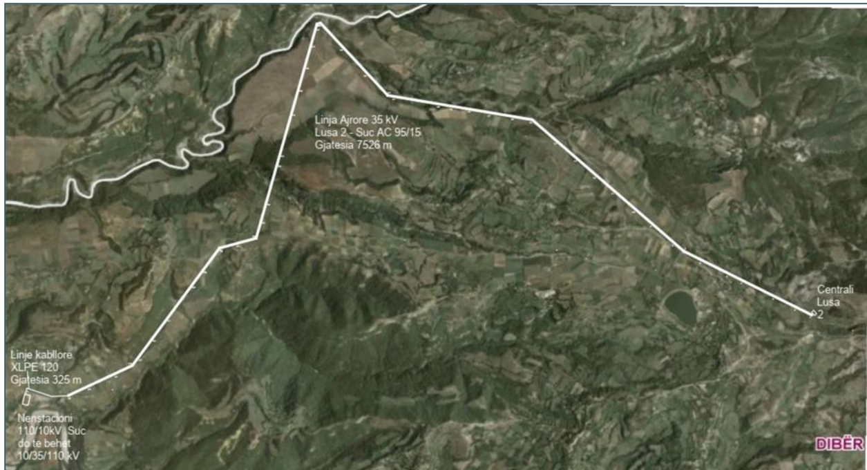
Linja 35 kV HEC "Lusa 2" - Nënstacioni 110/10 kV Suç
