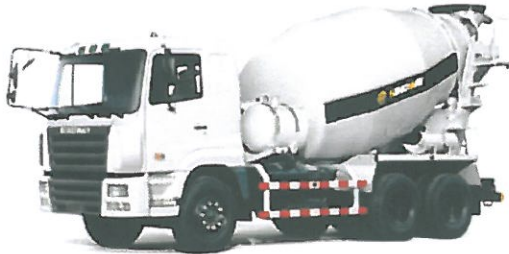
Mjet transportues i betonit.
