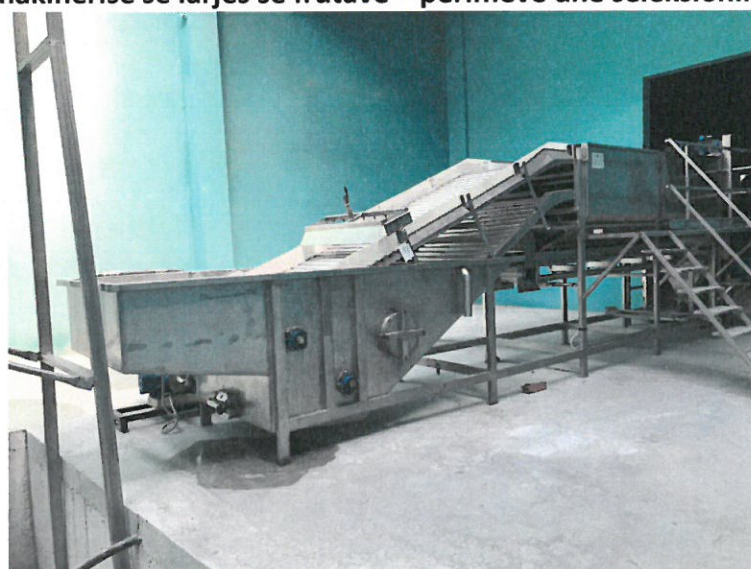
Foto te makinerise se larjes se frutave – perimeve dhe seleksionimit te tyre
