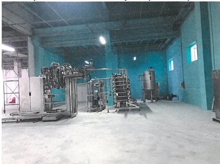
Makineria e pasterizimit dhe mbushjes se produktit perfundimtar
