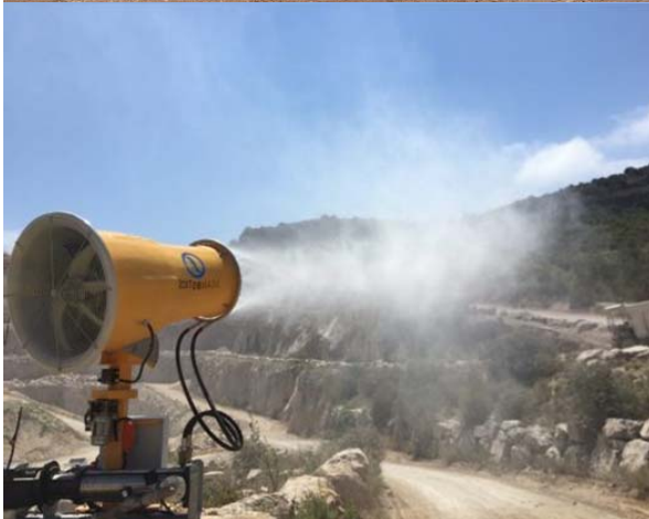
Figura 9. Pajisje për reduktimin e pluhurit të vendosura pranë burimit ku emetohen pluhurat
