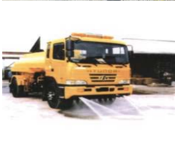
Figura 9. Pajisje për reduktimin e pluhurit të vendosura pranë burimit ku emetohen pluhurat
