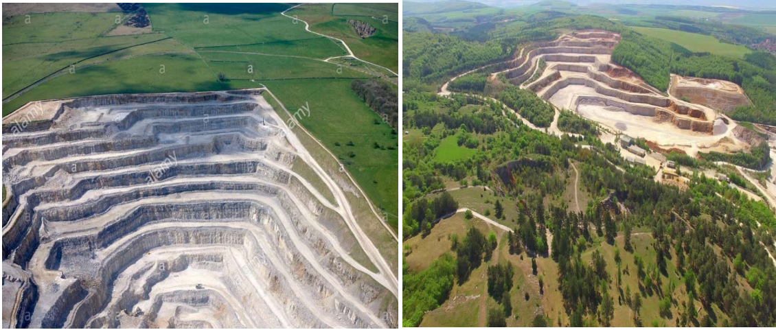
Figura 2. Shfrytëzim i karrierve, duke u nisur nga perimetri i jashtëm dhe duke zbritur në nivelet e mëposhtme deri në nivelet e shfrytëzueshme të mineralit
