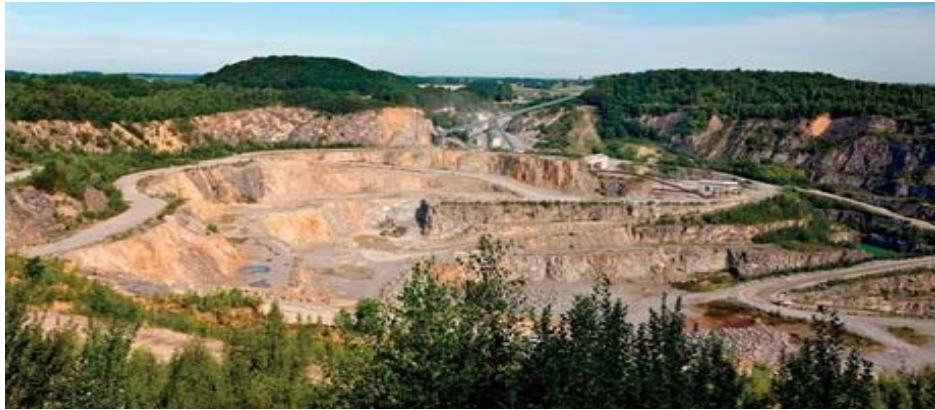
Figura 4. Mënyra e shfrytëzimit me shkallë e karrierës dhe rehabilitimi progresiv i zonës së shfrytëzuar
