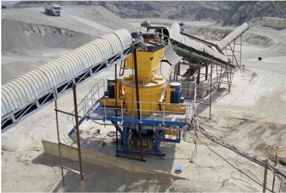
Figura 8. Mbulimi i transportierit të materialit me kapak për të reduktuar pluhurat nga kushtet atmosferike i lidhur me thyerësin e materialit
