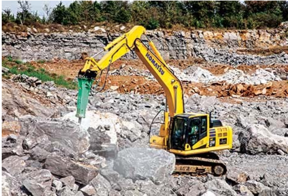
Figura 7. Thyerësi hidraulik i gurit
