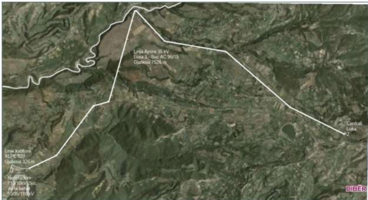
Figura 5: Linja HEC "Lusa 2" – Nënstacioni 110/10 kV Suç
