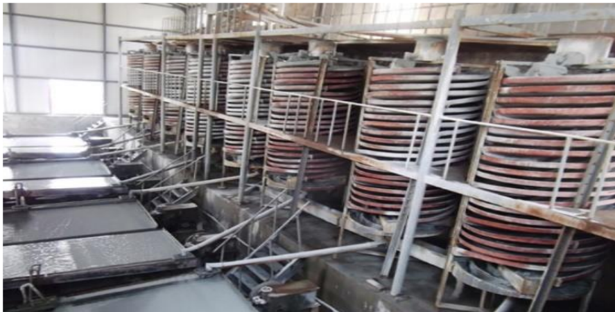
Govate spirale Densiteti I mineralit 25%-55% Kapaciteti procesues 4-6 ton ne ore Pesha 0.6 ton
