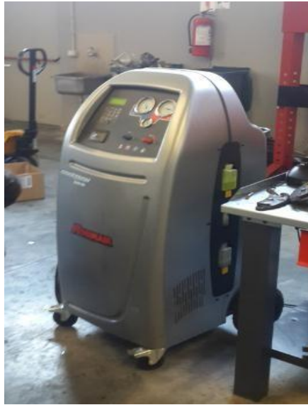
Figura 4: Pajisje per mbushjen me gaz ftohes te automjeteve
