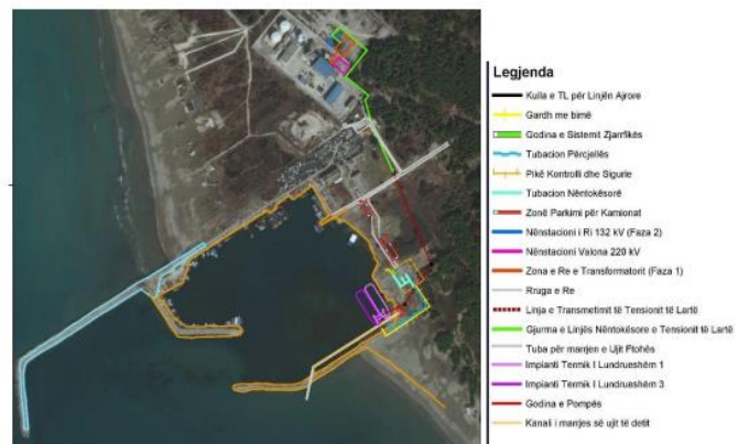
Figura 4 Planshtirje e funksionimit të Impiantit Termik Lëndueshëm me kapacitet 110 MWe në portin e Treporit në Vlorë, Shqipëri
