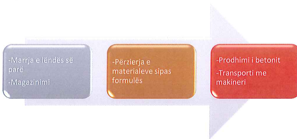
Figura 2-4 : Paraqitja ciklit të prodhimit të betonit
