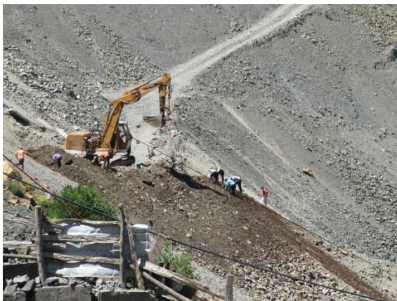
Pamje nga puna me mjete për nxjerrjen e mineralit të kromit nga mbetjet minerare
