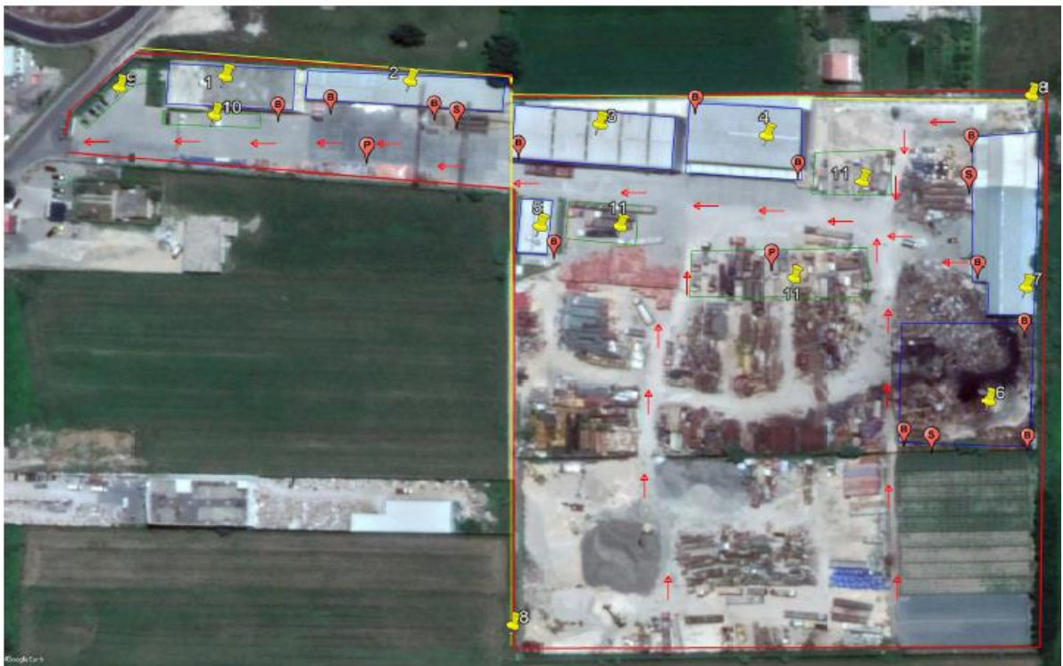
Figura 8. Plani i evakuimit dhe skica e përgjithshme e mjeteve dhe pajisjeve kundër zjarrit
