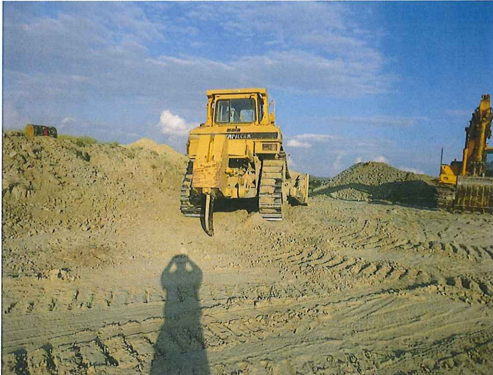
Foto makineri buldazier me thike per germ dhe eskavator per ngarkim argjili
