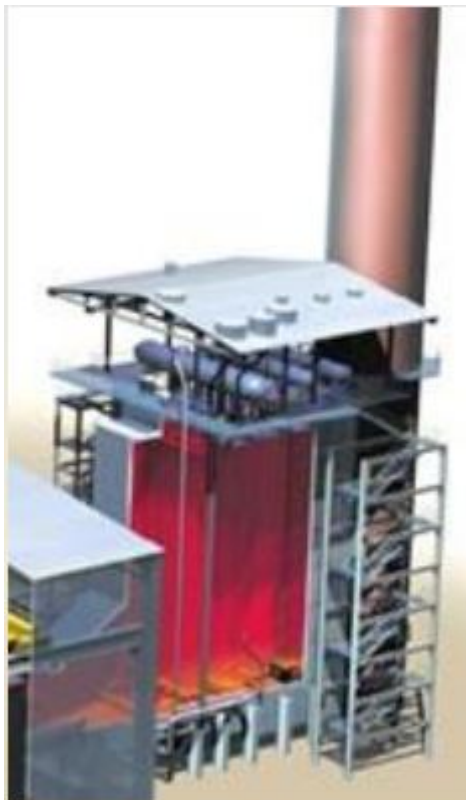
Figura 1.8 Pamje e gjeneratorit të avullit për rikuperimin e nxehtësisë (HRSG)
