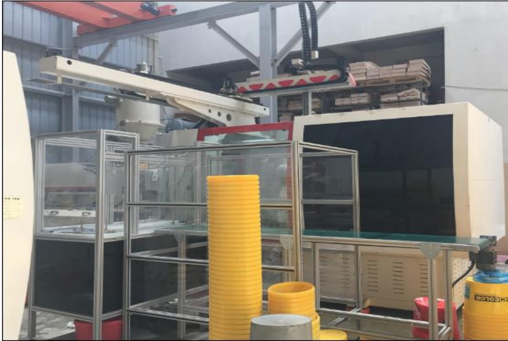
Figura 29. Makinaria Hurmak e cila sherben per formimin e kovave
